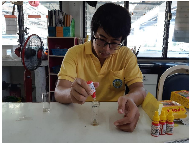
การตรวจค่าความเป็นกรด-ด่าง (pH) โดยนักวิชาการ
